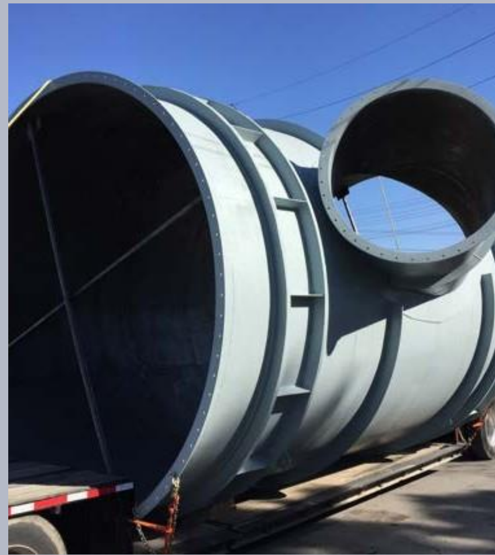
DUCTOS DE EXTRACCION
